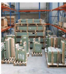
Схема (вверху) и пример (внизу) хранения секций шинного провода
